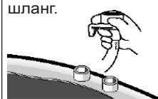
Выньте фильтр клапана налива воды.
