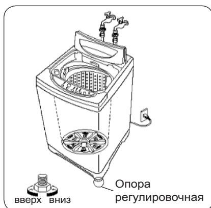
4. Установите машину строго горизонтально. При необходимости выставьте регулировочную опору таким образом, чтобы скомпенсировать неровности пола.
